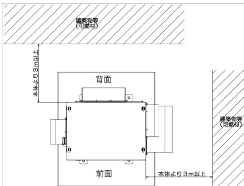
建築物等が不燃材料で造られ、開口部に防火戸が設けられている場合は、建築物等から 3m未満の距離でも設置できます。ただし、メンテナンススペースとして 1m 以上(背面作業窓側のみ 0.6m 以上)の離隔距離をとってください。
